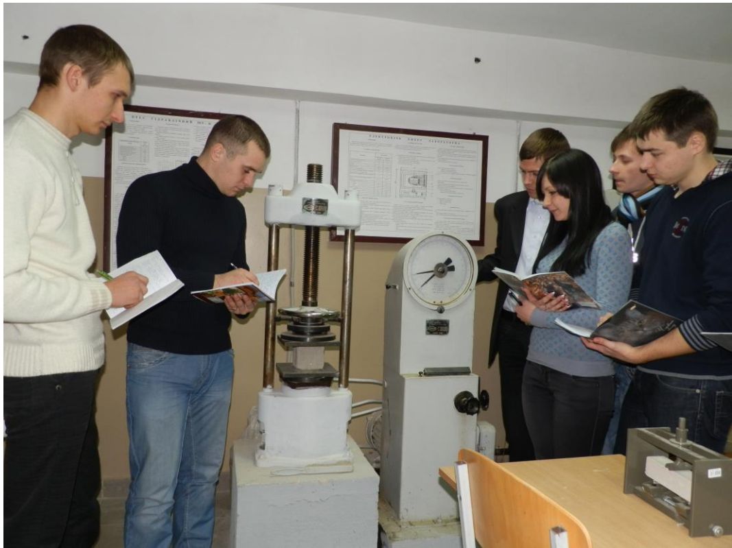
Завідувач лабораторіями Корнієць Ю.М. під час визначення марки бетону за кубиковою міцністю в лабораторії Будівельних матеріалів та конструкцій з групою ПЦБ-091 (2 лютого 2012 р.)
