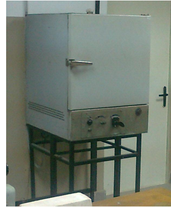
Рис. 12 – Електропіч опору камерна лабораторна СНОЛ
