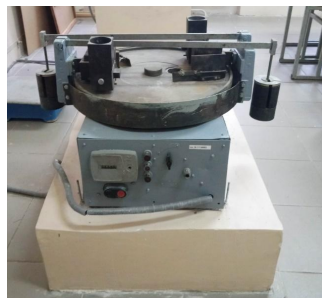
Рис. 18 – Віброплощадка лабораторна 435А
