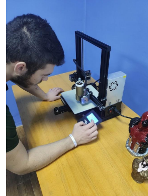
Рис. 33 – 3d принтер фірми Ender для друку воском або шоколадом
