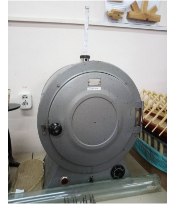
Рис. 13 – Шафа сушильна електрична кругла 2В-151
