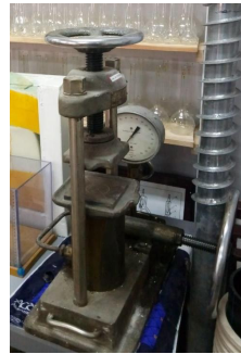
Рис. 5 – Прес гідравлічний з манометром типу ПГЛ-5
