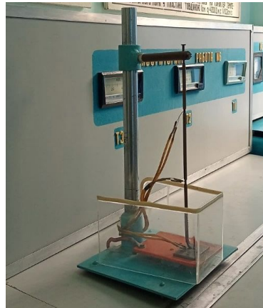
Рис. 27 – Лабораторний стэнд для дослідження впливу режимів зварювання на розподіл температур в пластині
