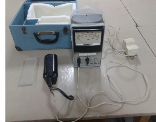
Рис. 3 – Вимірювач захисного шару ИЗС-10Н
