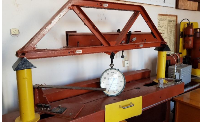
Рис. 35 – Лабораторний стэнд для визначення внутрішніх зусиль в металевих конструкціях
