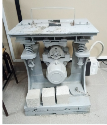
Рис. 11 – Віброплощадка лабораторна 435А
