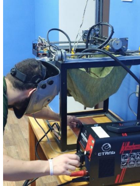
Рис. 31 – 3d принтер розроблений ЗВО для друку металами
