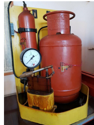
Рис. 38 – Лабораторний стэнд для дослідження оболонкових конструкцій
